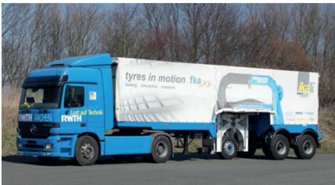
Bild 3 Mobiler Reifenprüfstand des ika der RWTH Aachen University [2]
